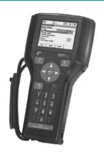
Коммуникатор модель 475 представляет собой искробезопасное портативное микропроцессорное устройство, предназначенное для считывания информации, настройки и конфигурирования интеллектуальных полевых приборов, поддерживающих цифровые протоколы передачи данных HART и Foundation Fieldbus. Коммуникатор поддерживает все устройства, зарегистрированные в HART Foundation и Foundation Fieldbus.
