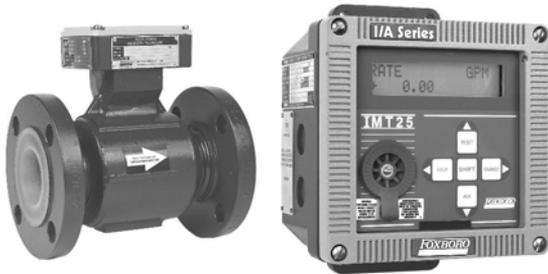
Электромагнитный расходомер, состоящий из датчика, сигнального кабеля и преобразователя, измеряет расход токопроводящих жидкостей (обычно водных растворов) и передает пропорциональный электрический сигнал. Полная информация о всех возможных опциях и характеристиках, а также инструкции по составлению заказа, приведена в документах «Технические характеристики изделия» PSS 1-6F2 A (серия 8000A), PSS 1-6F4 A (серия 9300A), PSS 1-6F9 A (серия 9100A), PSS 1-6F10 A (серия 9200A) и PSS 1-6F5 A (IMT25).
