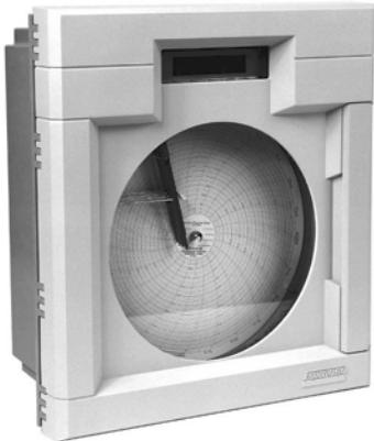
Цифровой регистратор 740R выполняет непрерывную индикацию и регистрацию на 12-дюймовый диаграммный диск до четырех электрических аналоговых сигналов. Микропроцессорная электроника прибора предлагает широкий выбор различных конфигурируемых пользователем функций, таких как сигнализация, накопительное суммирование, вычисления и характеристические кривые.
